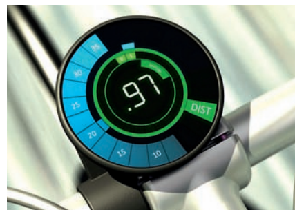
Farbige Displays im patentierten Electrowetting-Verfahren: Colorbright heißt die erste Produktplattform des Philips-Spin-offs Liquavista; typisch Niederlande – für Fahrradcomputer schon darstellbar.
